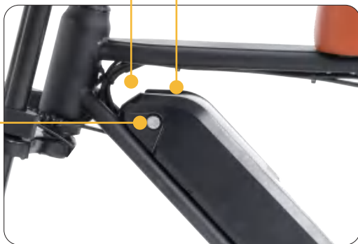
Puerto de carga e interruptor de desconexión de la batería
