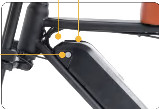
Port de recharge et interrupteur de déconnexion de la batterie
