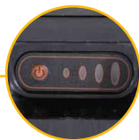
Indicateur de niveau de batterie et interrupteur (Visible lorsque la batterie est retirée)
